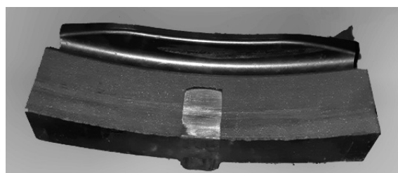
Рис. 1. Общий вид гребневой тормозной композиционной колодки UR 01-01 с чугунной вставкой Fig. 1. General view of the ridge composite brake shoe UR 01-01 with a cast iron insert
