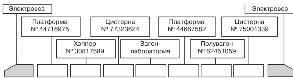
Рис. 6. Схема формирования опытного поезда Fig. 6. Scheme of the formation of a test train
