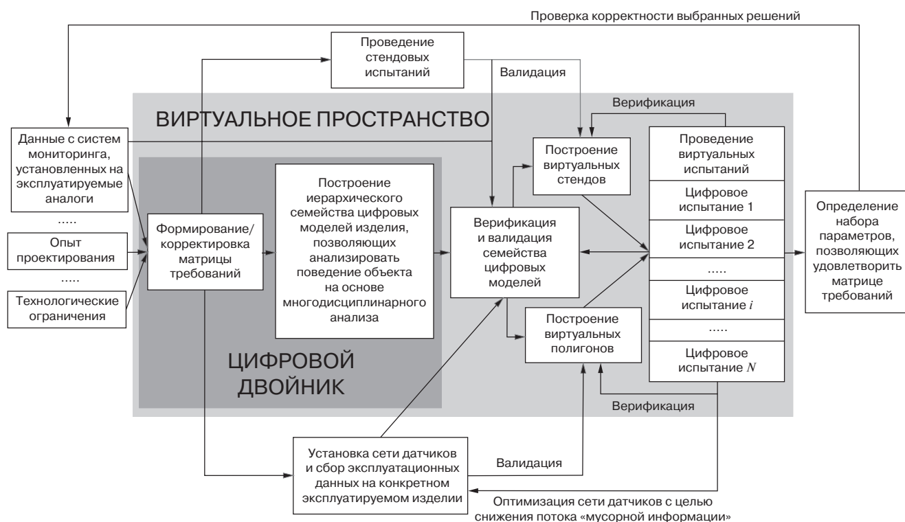
Рис. 3. Алгоритм построения цифрового двойника Fig. 3. Algorithm for constructing a digital twin
