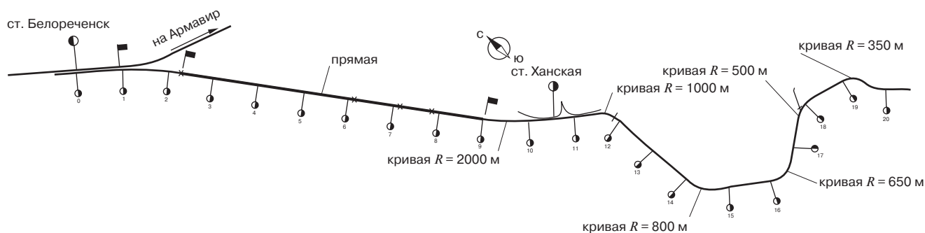
Рис. 5. Схема СИП АО «ВНИИЖТ» Fig. 5. Scheme of the High-Speed Testing Ground of JSC «VNIIZHT»
