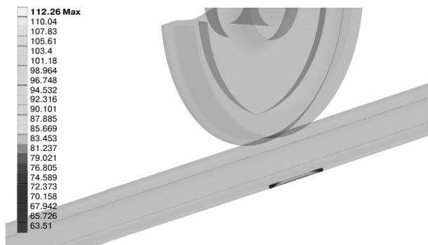
Рис. 5. Нормальные напряжения на наружной кромке подошвы рельса. Толщина балластного слоя 45 см, эпюра укладки 1600 шп./км, колесо между шпалами
