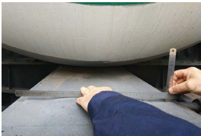
Рис. 1. Деформация верхнего листа хребтовой балки
