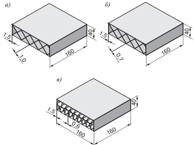
Рис. 5. Варианты вакуумных теплоизоляционных панелей: *a* — ребра жесткости в виде ромбов толщиной 1 мм; *б* — ребра жесткости в виде ромбов толщиной 0,7 мм; *в* — ребра жесткости в виде шестиугольных сот толщиной 0,6 мм
