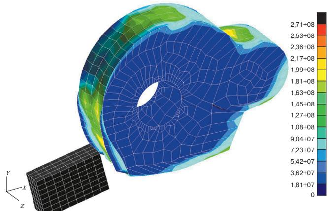
Рис. 7. Напряженно-деформированное состояние корпуса редуктора при скорости куска льда 200 км/ч и толщине стенок 10 мм
