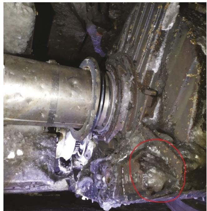
Рис. 2. Разрушение картера корпуса редуктора с образованием отверстия (выделено кружком) и последующим разрушением узлов тяговой передачи
