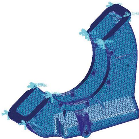
Рис. 15. Конечно-элементная модель части корпуса литого редуктора
