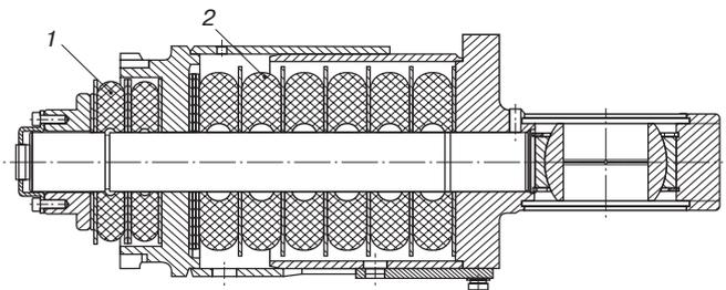
Рис. 5. Общий вид поглощающего аппарата Т-8П:
