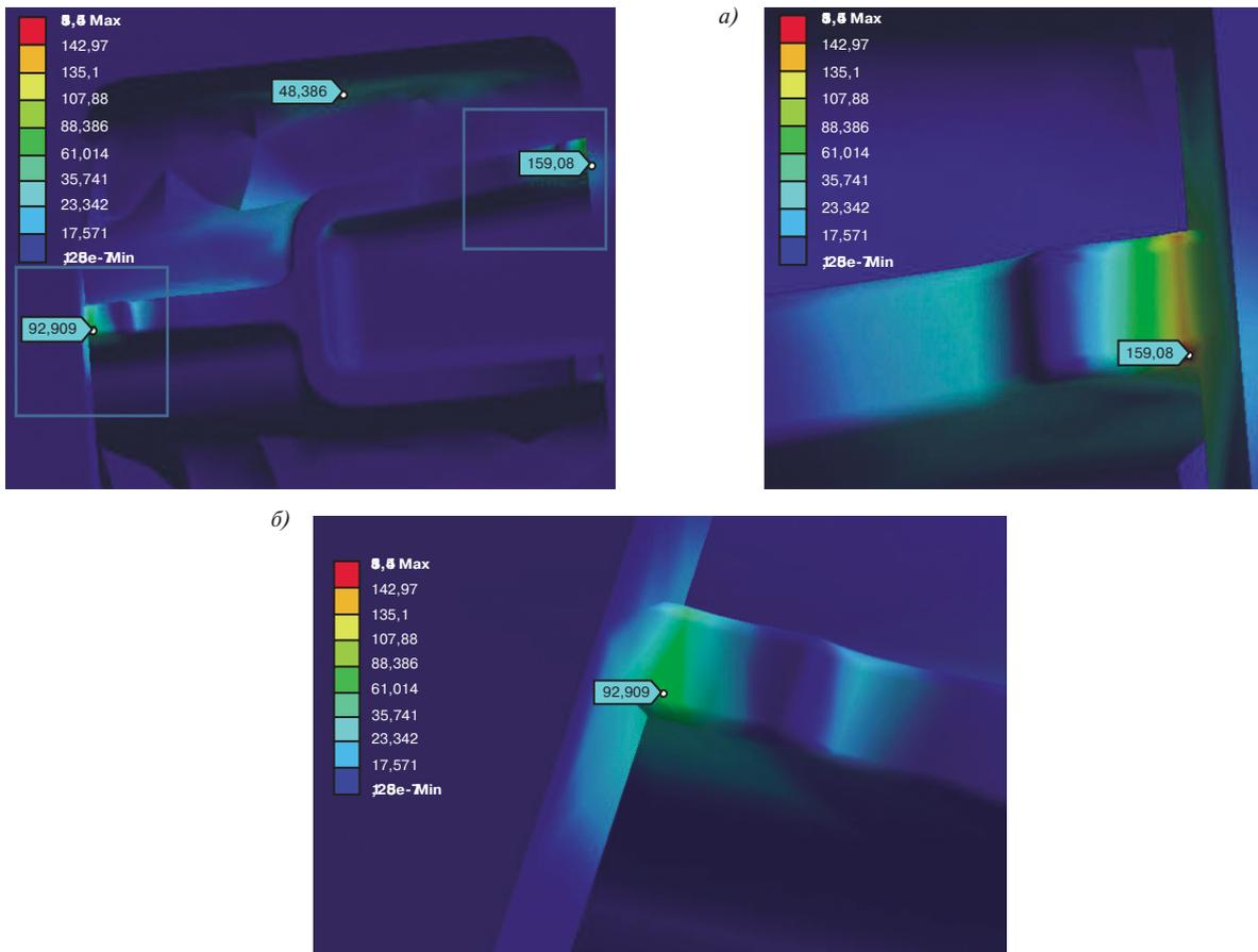
Рис. 9. Поле эквивалентных напряжений во второй опасной зоне для второй модели конструкции, МПа:
