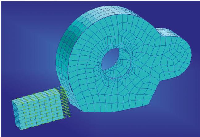
Рис. 3. Конечно-элементные модели куска льда и корпуса редуктора
