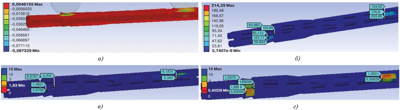
Рис. 7. Результаты расчета для восьмого момента времени в первой и второй опасных зонах для первой модели конструкции: *a* — абсолютная деформация по вертикальной компоненте, мм; *б* — эквивалентные напряжения по Мизесу, МПа; *в* — коэффициент запаса по статической прочности; *з* — коэффициент запаса по усталостной прочности
