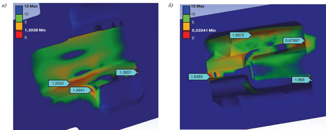
Рис. 10. Коэффициент запаса по усталостной прочности для второй модели конструкции:
