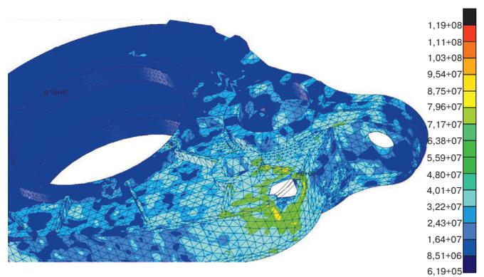
Рис. 12. Начало разрушения корпуса редуктора при скорости куска льда 45 м/с (160 км/ч) (модель материала Cowper—Simonds)
