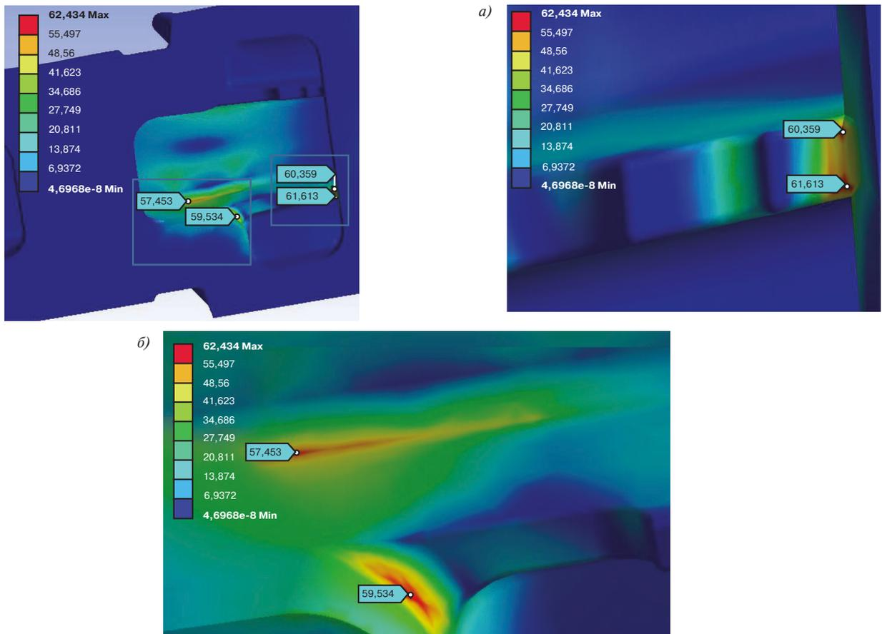
Рис. 8. Поле эквивалентных напряжений в первой опасной зоне для второй модели конструкции, МПа: *a* — правый выделенный фрагмент (увеличен); *б* — левый фрагмент (увеличен)
