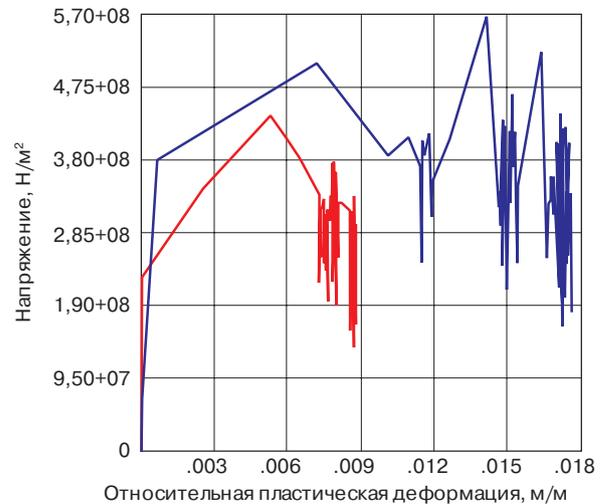
Рис. 21. Конечная фаза разрушения корпуса редуктора при скорости куска льда 79 м/с и зависимость напряжения от пластической деформации для узла конечных элементов в области разрушения. На графике синим цветом — деформация элемента конечно-элементной модели в окрестности области разрушения, красным — непосредственно в области разрушения
