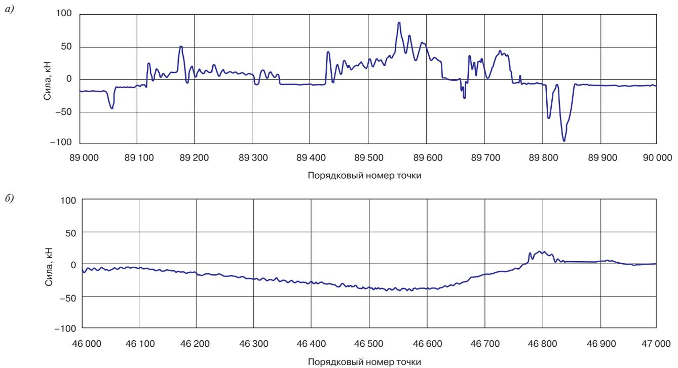
Рис. 1. Реализация продольных сил в межвагонных сцепках электропоезда при трогании и тяге:
