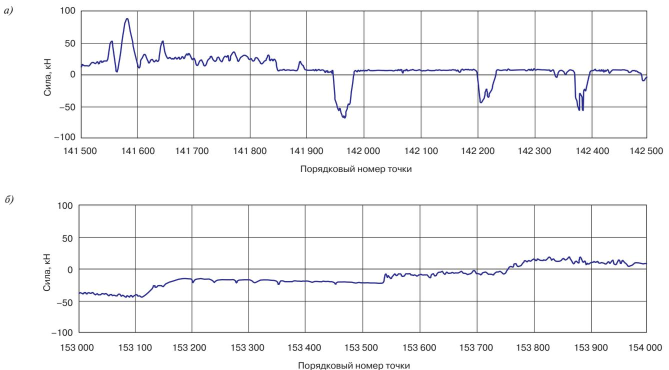
Рис. 2. Реализация продольных сил в межвагонных сцепках электропоезда в режиме тяги при скорости 70–80 км/ч:
