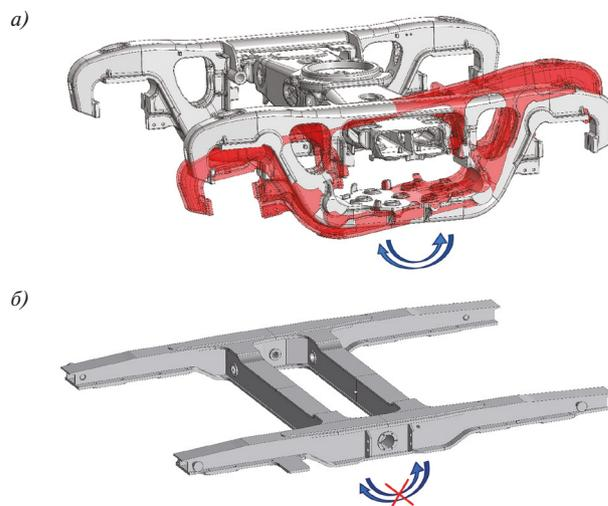
Рис. 1. Схематизированное представление восприимчивости несущих конструкций тележек к кососимметричным нагрузкам: а — сочленение несущих конструкций тележки модели 18-100; б — рама тележки жесткой сварной конструкции
