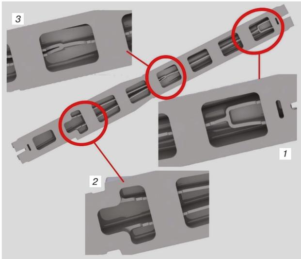
Рис. 3. Вторая модель конструкции со двоянными продольными ребрами жесткости:
