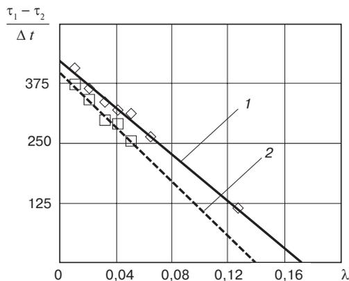
Рис. 4. Зависимости разности темпов нагрева первого и второго эталонных объектов от значений коэффициента теплопроводности  $\lambda$ :  $\square, \diamond$  — результаты расчета данных исследований виртуального стенда; 1 — регрессионная зависимость данных первого цикла исследований; 2 — регрессионная зависимость данных второго цикла исследований
