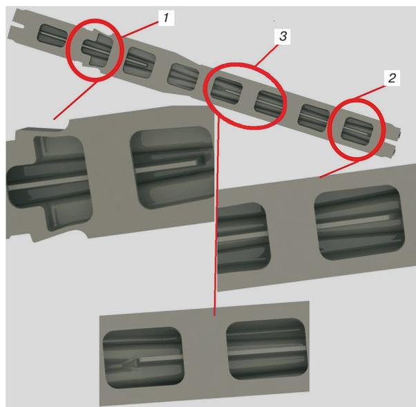
Рис. 2. Первая модель конструкции с одиночными продольными ребрами жесткости:
