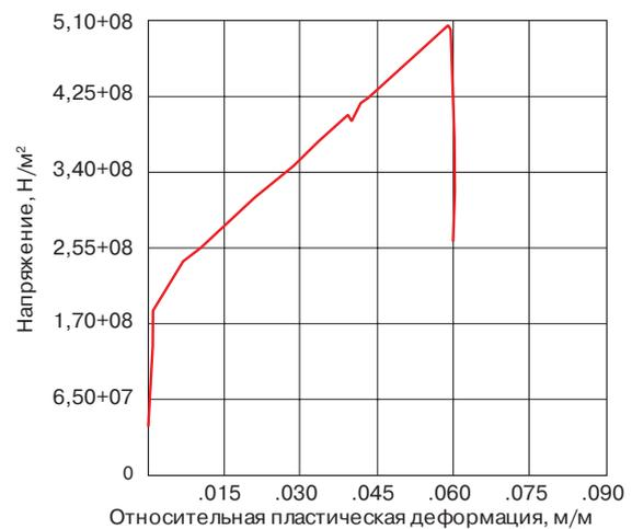
Рис. 18. Зависимость напряжения от пластической деформации для двух узлов конечных элементов в области разрушения при скорости воздействия 79 м/с
