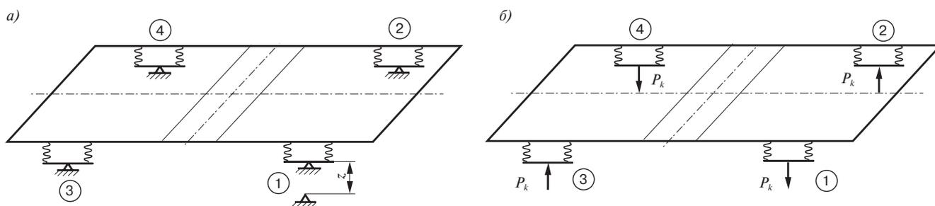
Рис. 3. Схема действия кососимметричных сил при сходе колеса с рельса: а — перемещение колеса  $z$  при сходе с рельса; б — система взаимно уравновешенных вертикальных кососимметричных сил  $P_k$ , возникающих в раме при сходе: 1, 2, 3, 4 — условный номер колеса
