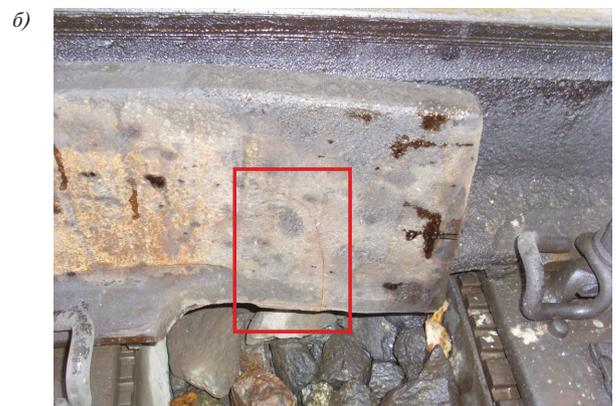
Рис. 12. Трещины литой части цельнолитого блока моноблочной крестовины в районе улавливающего желоба: а — вид слева; б — вид справа
