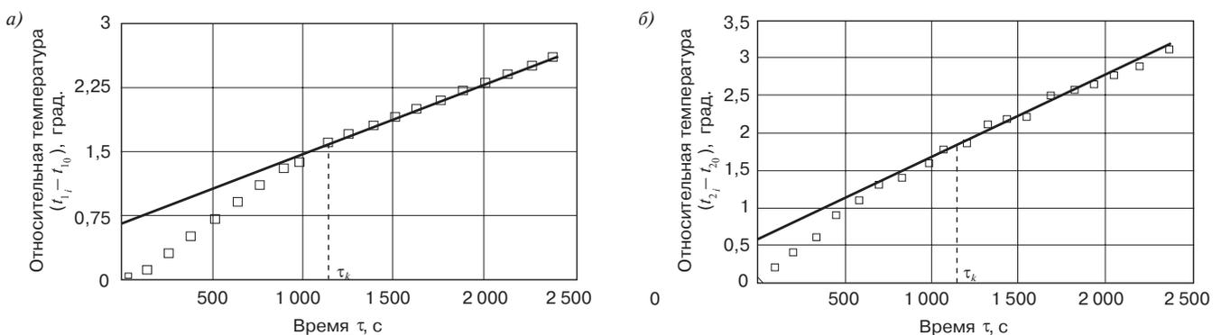
Рис. 2. Регрессионные зависимости относительной температуры первого (а) и второго (б) эталонных объектов от времени в виде полинома первого порядка
