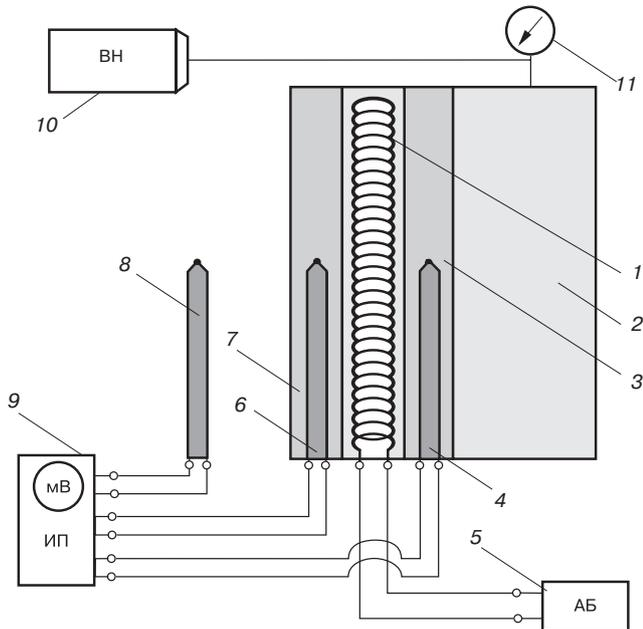
Рис. 1. Стенд для измерения удельного теплового сопротивления теплоизоляционных материалов: 1 — нагреватель; 2 — вакуумная теплоизоляционная панель; 3 — второй эталонный объект; 4, 6, 8 — термпары; 5 — источник электрической энергии (аккумуляторная батарея, 24 В); 7 — первый эталонный объект; 9 — измерительный прибор; 10 — вакуум-насос; 11 — вакуумметр
