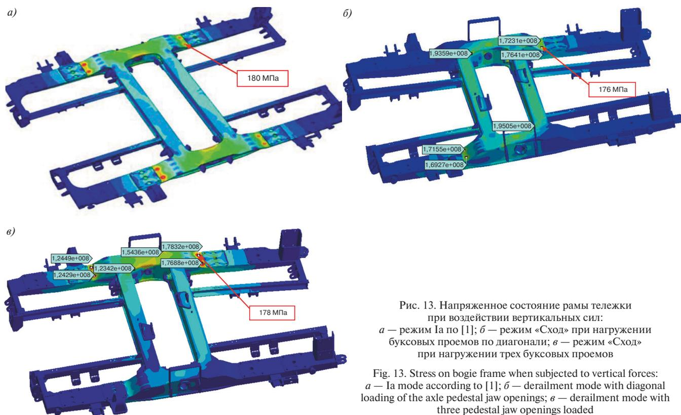
Рис. 13. Напряженное состояние рамы тележки при воздействии вертикальных сил: *a* — режим Ia по [1]; *б* — режим «Сход» при нагружении буксовых проемов по диагонали; *в* — режим «Сход» при нагружении трех буксовых проемов
