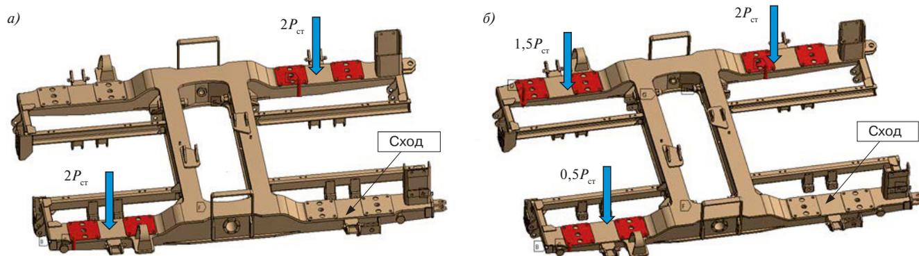
Рис. 12. Расчетные случаи нагружения рамы тележки для оценки ее прочности от воздействия кососимметричных нагрузок:
