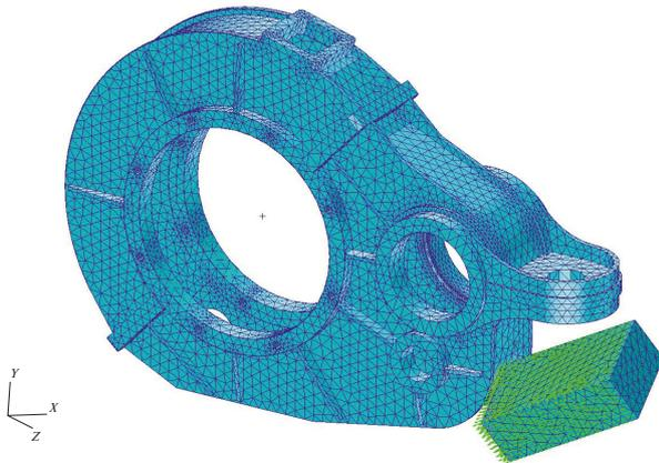
Рис. 10. Уточненная конечно-элементная модель корпуса редуктора и модель куска льда
