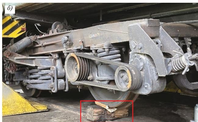
Рис. 10. Имитация схода с провалом первого по ходу движения колеса: *a* — обезгруживание первого колеса; *b* — опускание кузова вагона с тележкой на опоры, установленные под три колеса
