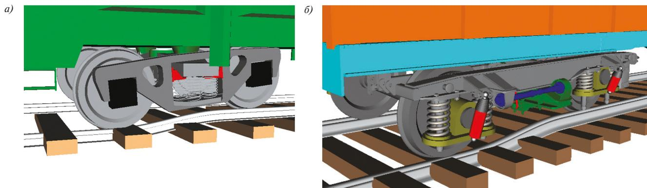
Рис. 6. Моделирование схода колеса с рельса тележки модели:
