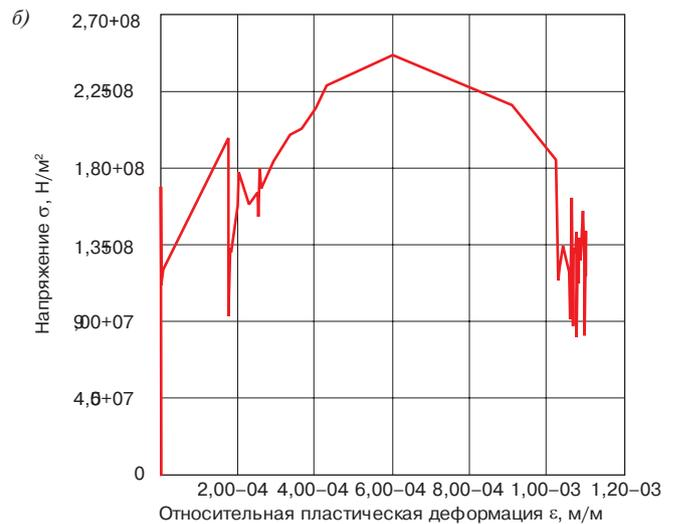
Рис. 14. Зависимость напряжения от пластической деформации для узла конечных элементов в окрестности области разрушения корпуса редуктора. Заданное максимальное значение пластической деформации 2,5%:
