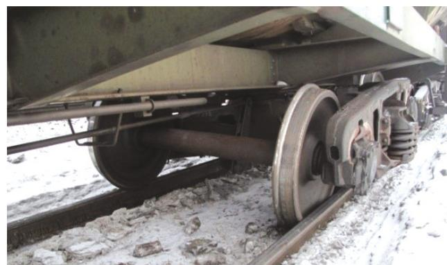
Рис. 2. Случаи проваливания колеса внутрь колеи
