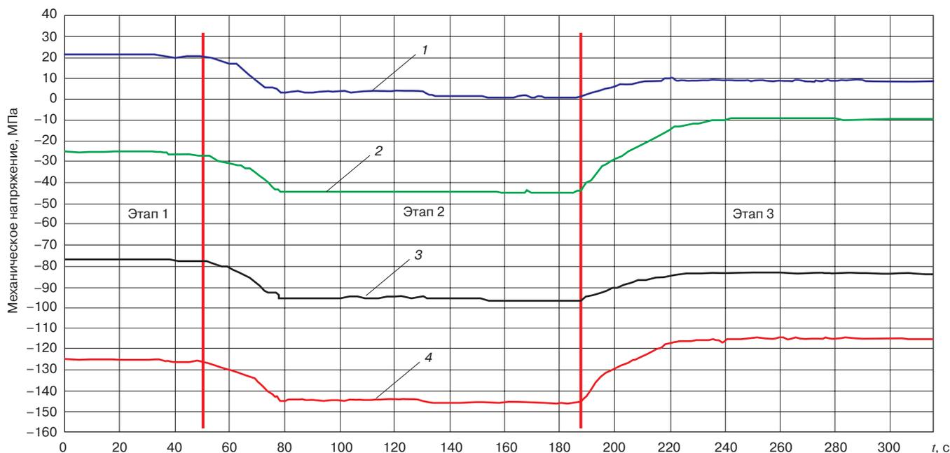
Рис. 11. Осциллограмма перераспределения нагрузок на раму тележки при сходе колеса:
