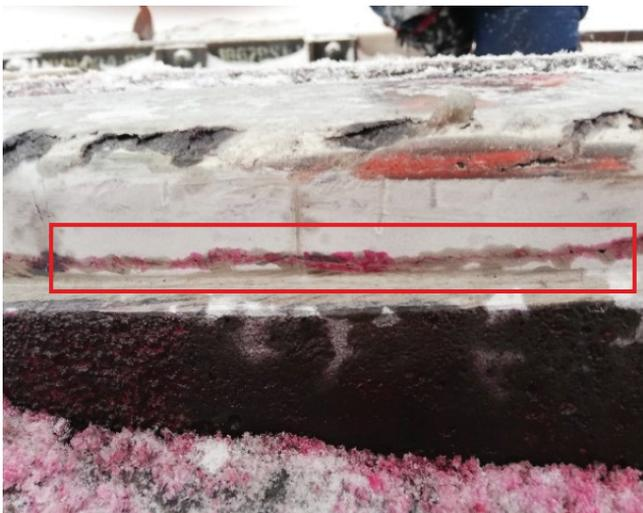
Рис. 13. Результат проверки трещины методом цветной дефектоскопии, подозрение на дефект ДС.30Г.2 [12, с. 155]
