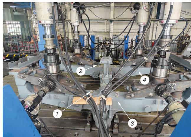
Рис. 4. Зона образования трещин на раме тележки: 1 — зона образования трещины № 1; 2 — зона образования трещины № 2; 3 — боковина № 1; 4 — боковина № 2
