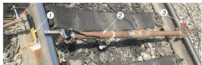
Рис. 3. Общий вид тарировочного устройства тензодатчиков для измерения боковых сил: 1, 3 — измерительные балочки; 2 — силовое тарировочное устройство
