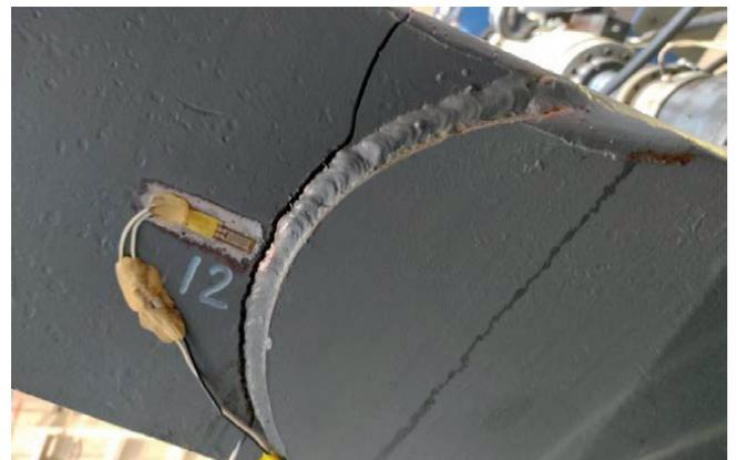
Рис. 10. Трещина в нижнем листе боковины в районе сварного шва соединения нижнего листа с усиливающей накладкой
