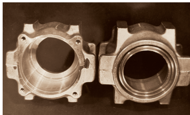
Рис. 6. Корпус буксы из штампованной заготовки КраМЗ. Слева — вид передней стороны, справа — вид со стороны лабиринта
