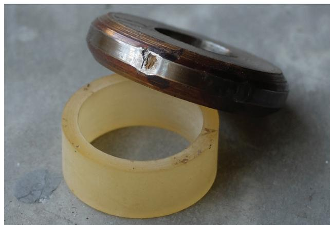
Рис. 7. Образец с контактно-усталостной выщербиной
