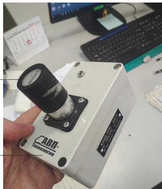
Рис. 16. Картридж с информацией и считывающее устройство ИСАВП-РТ компании АВП «Технология»:
