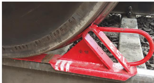
Рис. 1. Стояночный башмак производства ФГУП «ПО «Октябрь»», 2018 г.
