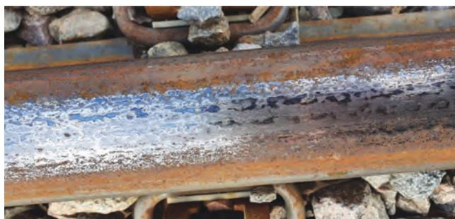
Рис. 11. Пятна металла, перенесенного на рельс с башмаков
