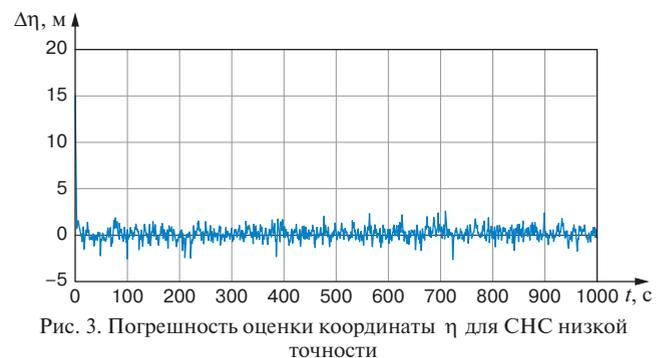
Рис. 3. Погрешность оценки координаты  $\eta$  для СНС низкой точности
