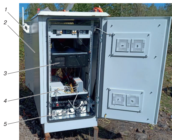
Рис. 2. Стационарный пост автоматической регистрации сил в системе «колесо — рельс» для оценки динамики взаимодействия экипажа и пути (общий вид):
