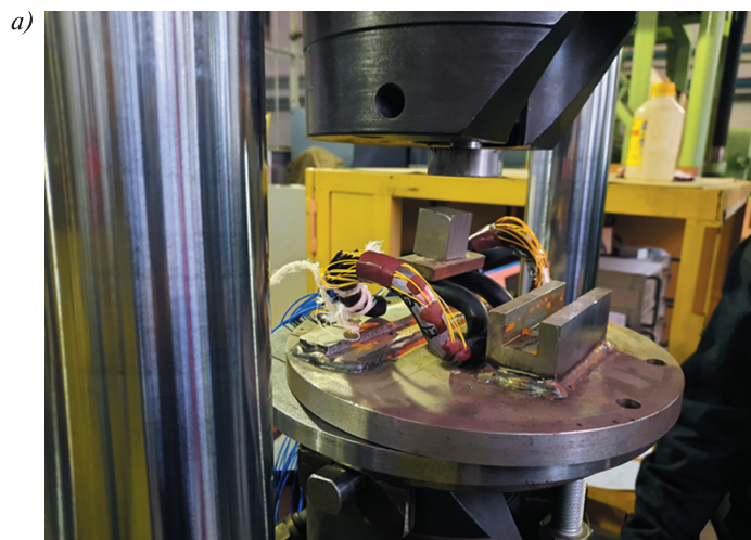
Рис. 8. Стендовые испытания упругой клеммы на универсальной машине для испытаний материалов ИК-100.01М*: а) установленная в ложементе клемма, оборудованная тензорезисторами для измерения напряжений кручения и изгиба; б) процесс нагружения клеммы вертикальной силой и перемещения центральной петли упругой клеммы * Источник: фото авторов
