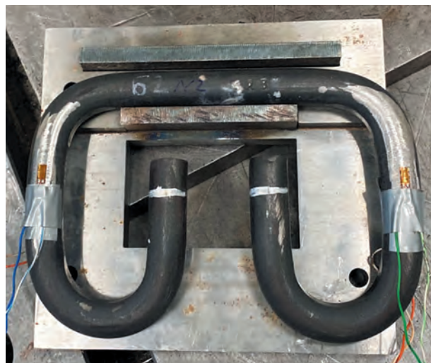
Рис. 3. Фото клеммы с наклеенными тензорезисторами (вид сверху)*
