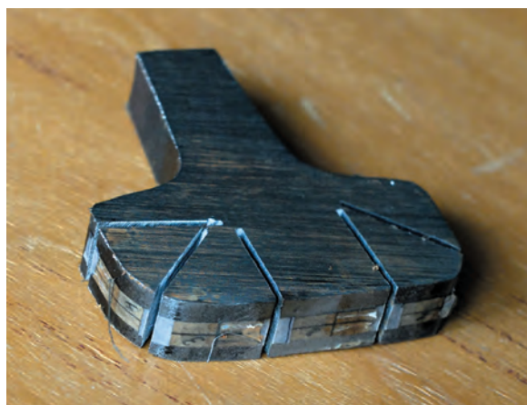
Рис. 8. Срез с поперечными тензорезисторами с вырезами* * Источник: фото авторов
