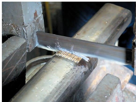
Рис. 7. Выполнение поперечного разреза рельса ленточной пилой* * Источник: фото авторов
