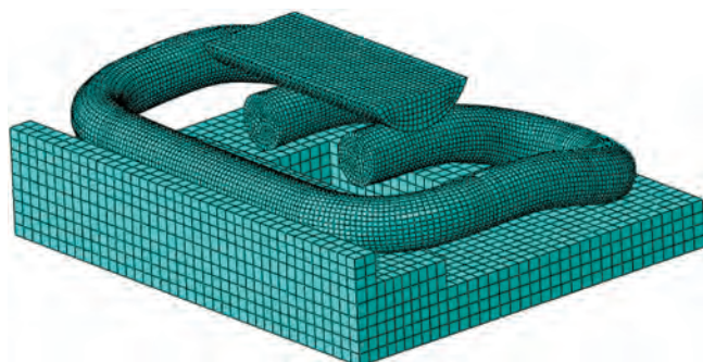
Рис. 6. Конечно-элементная модель клеммы, опорной плиты и нагружающего приспособления*
