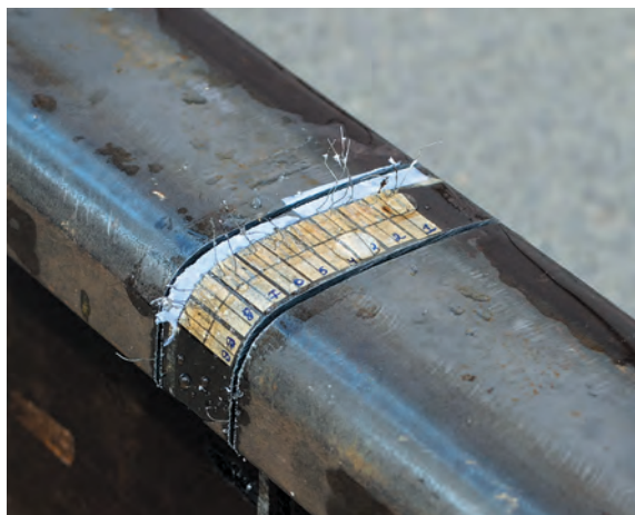
Рис. 5. Расположение продольных тензорезисторов* * Источник: фото авторов
