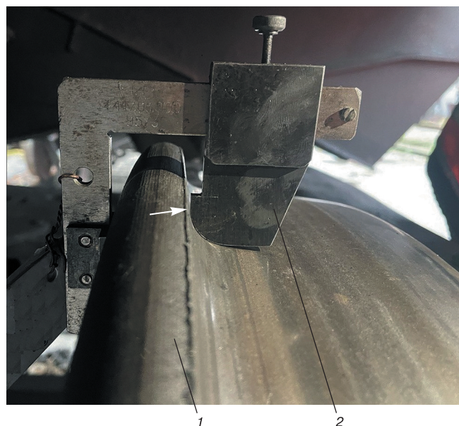
Рис. 3. Контроль вертикального подреза гребня специальным шаблоном*. Отсутствие зазора свидетельствует о наличии вертикального подреза:
